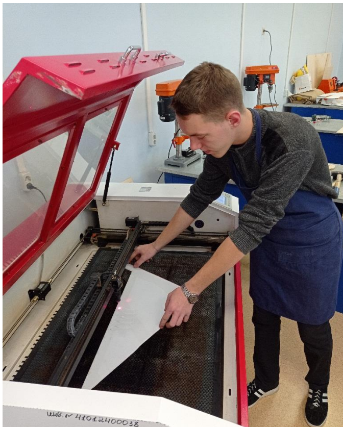
Рисунок 7. Резка заготовок из акрила на лазерном станке с ЧПУ
