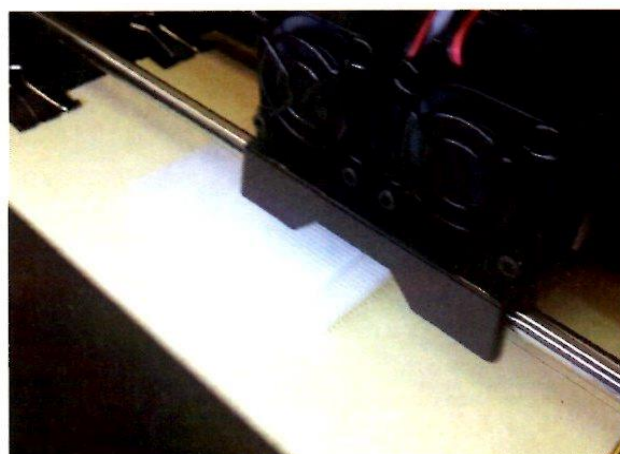
Процесс печати корпуса устройства
